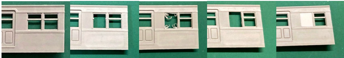
窓埋めの工程
